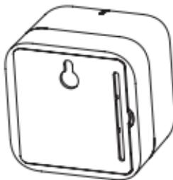
2. El indicador luminoso LED hace un destello CADA 5 SEGUNDOS y el dispositivo empieza a actuar. Cuando el indicador luminoso no se encienda o escuche una señal intermitente, debe sustituir las pilas.
