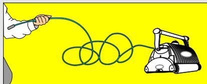
Coloque el Robot en el suelo y desconecte el cable del transformador. Con una mano sujete el Pivote E-Z camine alejándose del Robot mientras estira el cable en toda su longitud
