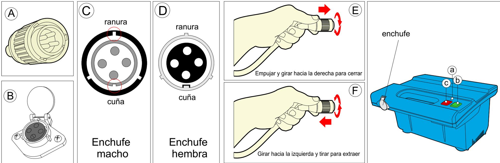
Para conectar el cable eléctrico (fig. A ) en el enchufe hembra del transformador ( fig. B ) por favor, haga lo siguiente :
