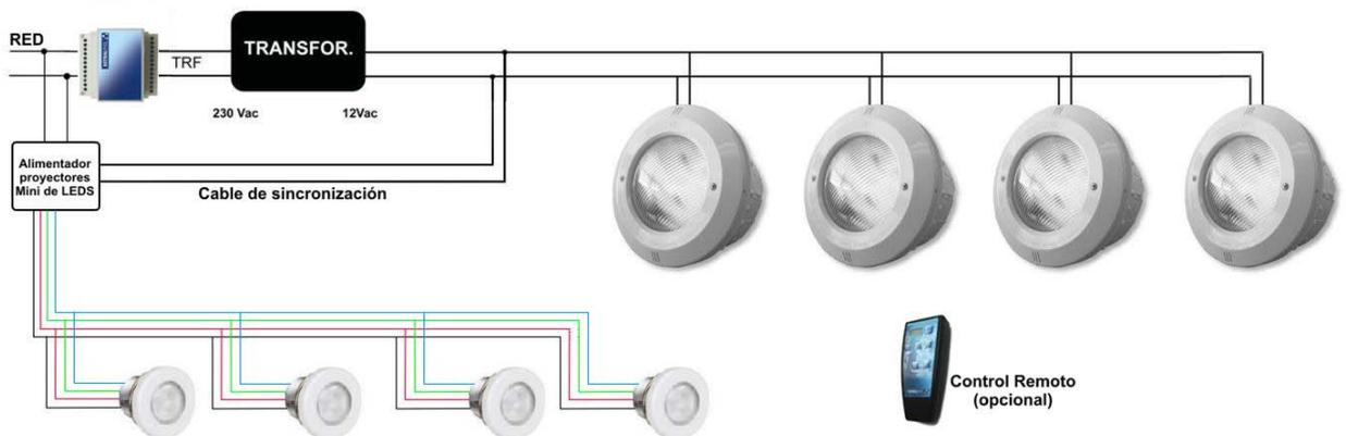
Esquema 4: proyectores PAR 56, Std o Planos con proyectores Mini de LEDS – funcionamiento mediante receptor-modulador
