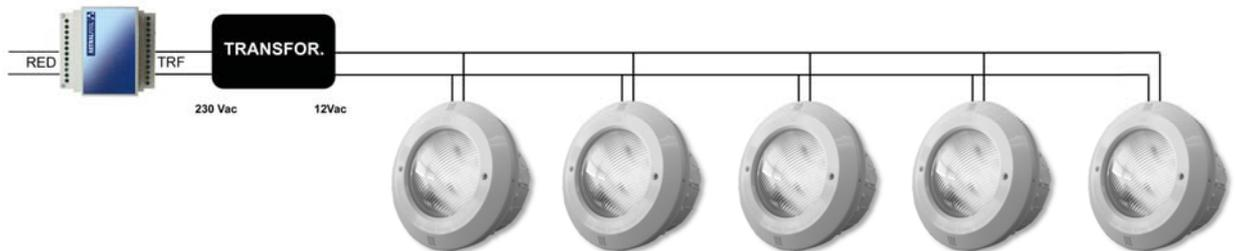
Esquema 3: proyectores PAR 56, Std o Planos de LEDS – funcionamiento mediante receptor-modulador.
