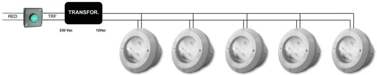
Esquema 1: proyectores PAR 56, Std o Planos de LEDS – funcionamiento mediante pulsador
