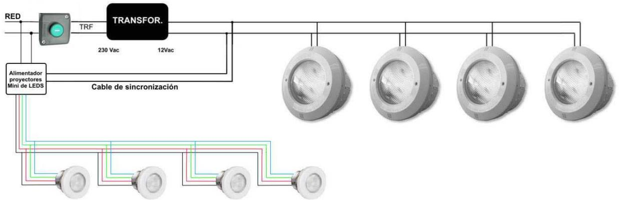
Esquema 2: proyectores PAR 56, Std o Planos con proyectores Mini de LEDS – funcionamiento mediante pulsador
