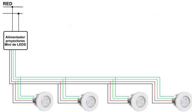
Esquema 5: proyectores Mini (1 alimentador y 4 proyectores Mini) – funcionamiento mediante pulsador
