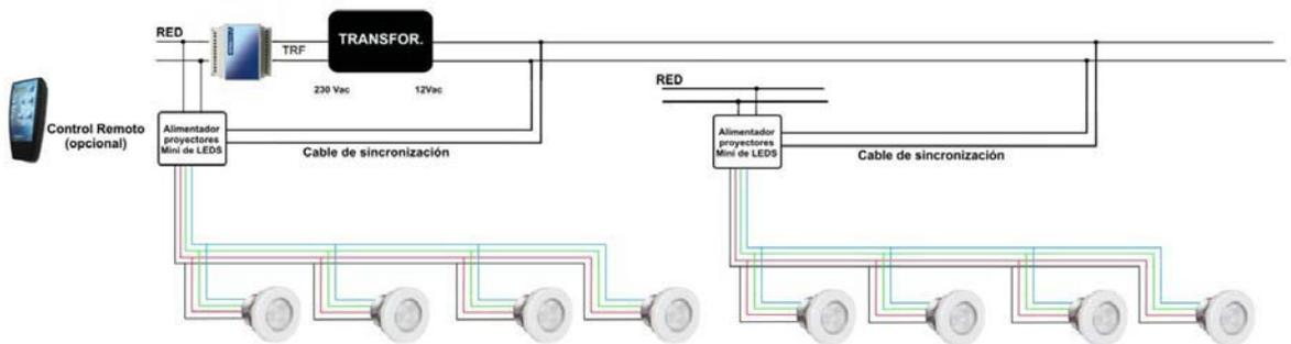
Esquema 7: proyectores Mini (2 alimentadores y 8 proyectores Mni) – funcionamiento mediante receptor-modulador
