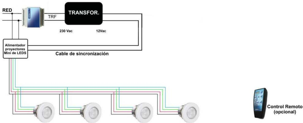
Esquema 6: proyectores Mini (1 alimentador y 4 proyectores Mini) – funcionamiento mediante receptor-modulador
