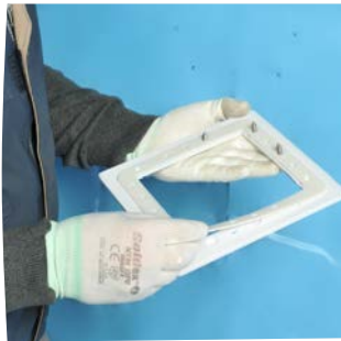
Coloque la junta sobre la brida
