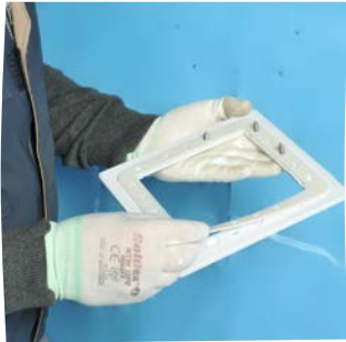
Setzen Sie die Dichtung auf den Flansch
