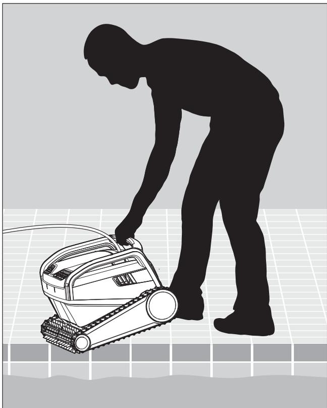
**5.2.1** Coloque el Limpiafondos Automático en la piscina. Suéltelo y deje que se hunda hasta el fondo de la piscina. Asegúrese de que el cable flotante no encuentra ningún obstáculo.
