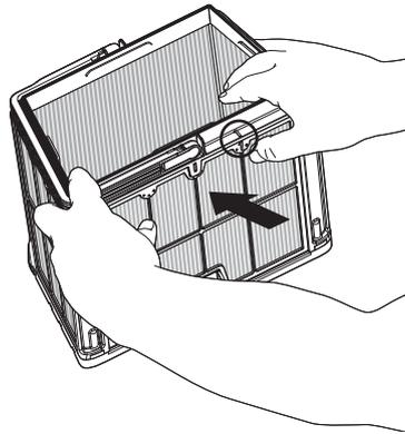
**6.2.2** Desmonte los paneles; comience presionando el panel 1, usando sus pulgares.
