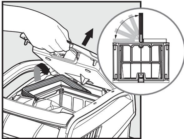
**6.1.2** Al abrir la cubierta del filtro, el asa se levantará sola.
