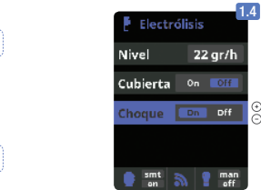
1.4 Choque: Filtración durante 24h a intensidad máxima. Retorno al modo de filtración programado.
