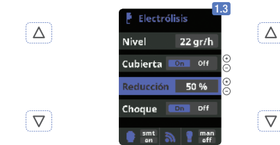
1.3 Cubierta: Conexión de la cubierta automática. Reducción a porcentaje de producción de cloro cuando se cierra la cubierta.
