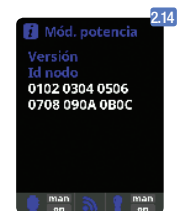
2.14 Info del sistema: Información de la versión de software disponible de la pantalla TFT y el módulo de potencia.
