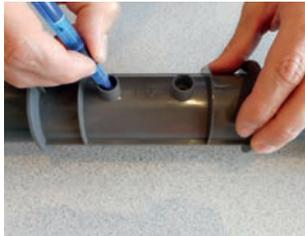
Adaptador de tubo DN50 mm
