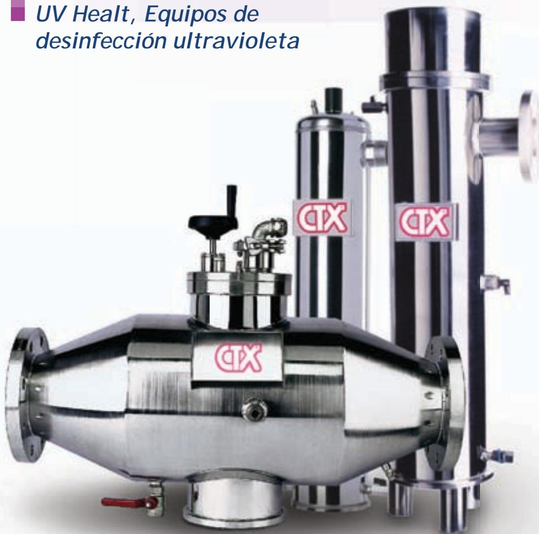
La esterilización a partir de radiación ultravioleta tiene como aplicación muy importante el tratamiento de aguas de piscinas. La radiación sobre los gérmenes presentes en el agua con ultravioletas, provoca daños sobre la estructura del ADN de bacterias impidiendo su división celular, causando su muerte. Esta acción es extremadamente eficaz con una longitud de onda de 254 nm, en una dosis de 25 mJ/cm<sup>2</sup>, hasta 80 mJ/cm<sup>2</sup> para los distintos caudales que se requieran
