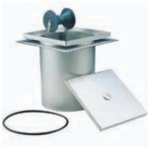
Permite el almacenamiento de corcheras en la parte inferior de la instalación. Fabricado en acero inoxidable AISI-316, se compone del cuerpo recogedoras, que queda empotrado en el pavimento de la piscina y en el cual se sitúa el mecanismo escamoteable con la rueda que será el apoyo en el momento de la recogida de las corcheras. El recogedoras queda disimulado mediante una tapa superior panelable. Este artículo podrá complementarse en caso necesario con un saco recogedoras.
