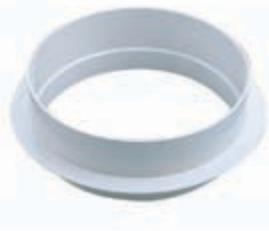
Distanciador adicional para poder aumentar la distancia entre la boca del skimmer de 15 l y la tapa. Distancia alargamiento 25 mm. Fabricado en ABS. Sobreponiendo diferentes acoplamientos se puede aumentar en altura. También puede inclinarse ligeramente para nivelarse con el terreno.
