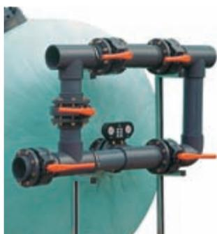
Baterías de válvulas manuales o motorizadas fabricadas con tubería de PVC en PN-10 con bridas de conexión al filtro s/norma DIN-2501.
