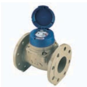
Contador de turbina axial, tipo Woltman, de lectura directa en rodillos numerados. Contador de esfera seca con transmisión magnética. Relojería y turbina fácilmente extraíble. Preequipo para emisión de impulsos. Grado de protección IP-68. Emisor de impulsos tipo CYBLE.
