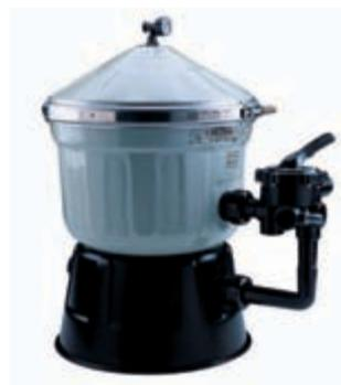
Filtros de diatomeas Clarity contruidos en poliéster y fibra de vidrio. Equipados con manómetro, purga de aire y válvula selectora lateral. Carga de diatomeas no incluida. Velocidad de filtración 4,9 m<sup>3</sup>/h/m<sup>2</sup>.
