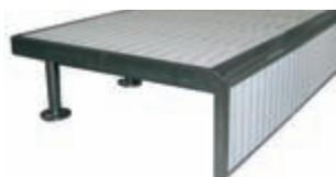
AstralPool ha creado una plataforma donde fijar los podiums de salida. Mediante esta incorporación ampliamos nuestra gama de productos para la competición. El producto está compuesto por una bancada en AISI-304 y rejillas en material plástico. La plataforma también puede utilizarse como panel de viraje e incorpora las fijaciones para las corcheras.
