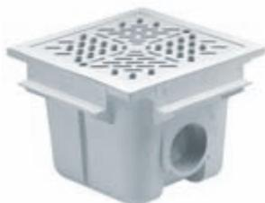
Salida lateral 2". Cuerpo y rejilla en ABS color blanco. Fijación rejilla mediante tornillos. Caudal máx: 13 m³/h.
