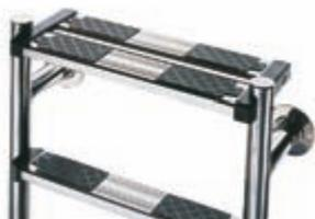
Según normativa europea EN 13451-1 y EN 13451-2. Peldaños y pasamanos Ø 43 mm en acero inox AISI-316 pulido brillante. Se complementan combinándolas con cualquier modelo de salidas. Fijación con pletinas, juntas elásticas, tacos anclaje y tornillos.
