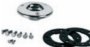
Fabricada en acero inoxidable AISI-316. Adaptable a pasamuros 00344, 00345 y convertidor 26171. Con juntas y tornillos. Bola Ø 20 mm. Fijación bola mediante tornillos. Caudal recomendado: 4,5 m<sup>3</sup>/h.
