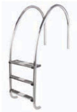
Incorpora la curvatura con radio variable en el tramo de agarre dando un aspecto más moderno y atractivo. Peldaños de 500 mm de ancho y fabricada según normativa europea EN 13451-1 y EN 13451-2. Fácil instalación. Pasamanos de Ø 43 mm x 1,5 mm y peldaños en acero inox AISI-316 acabado pulido brillante. Disponen de anclajes previstos para conexión al circuito equipotencial. Nota: No permiten el montaje en anclajes códigos 00043, 08727, 07331, 18243 (página 23).
