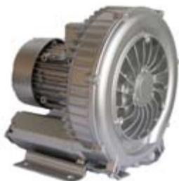
El rodete, dotado de pequeñas aletas, gira en el interior del canal lateral provocando que el aire aspirado se comprima y acelere formando remolinos que son arrastrados hacia la boca de salida. No existen partes en contacto entre el rotor y el estator; esto significa que las turbinas no necesitan lubricación ni mantenimiento ordinario.
