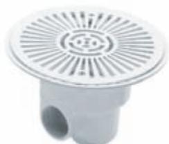
Salida inferior de 1½" y lateral de 2". Construido totalmente en ABS color blanco. Salida lateral con posibilidad de instalación de un tapón para pruebas de estanqueidad. Salida inferior con tapón y posibilidad de montaje de válvula hidrostática (Cód. 00277) y tubo drenaje (Cód. 21581). Reja de aspiración Ø 250 mm. Caudal máx: 13 m³/h.
