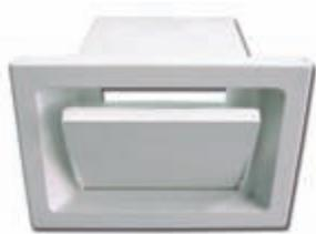
El adaptador de skimmer evita la extracción del skimmer antiguo, ya que se inserta en el interior del mismo, consiguiendo el sellado mediante cola de ABS o silicona marina. Solo es apto para skimmer con boca interior de medidas 140 mm x 201 mm
