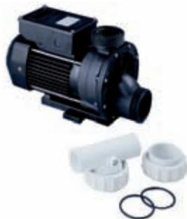
Cuerpo en ABS y 75% FV. Motor de 0,37 kW (0,5 CV). Protección conexión eléctrica IP-55 220 V 1~50Hz. Conexión aspiración 2" macho. Conexión impulsión 1 1/2" macho.
