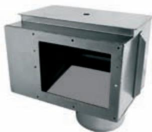
En inox AISI-316. Con rebosadero de Ø 50 mm, cesto y tapa en inox, ambos incluidos. Dispone de alojamiento para montar válvula reguladora de nivel 00256. Con conexión para toma equipotencial. Caudal recomendado: 7,5 m³/h. No incluye embellecedor cód. 00255.
