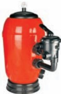
Laminado en poliéster reforzado con FV. Color rojo, pie en polipropileno, tapa sin tornillos, tapón para vaciado de arena y agua, manómetro y purga de aire incorporado en la tapa y válvula selector lateral. Velocidad máx. de filtración 50 m<sup>3</sup>/h/m<sup>2</sup>. Presión máxima de trabajo: 2,5 kg/cm<sup>2</sup>. Altura lecho filtrante 0,6 m.
