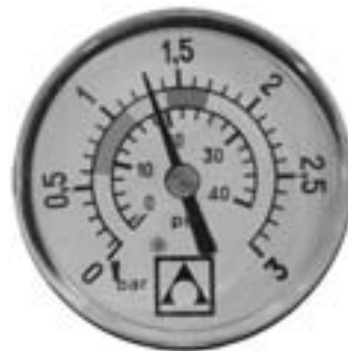
1,3 kg/cm 2 - 18,5 PSI: Esta presión indica que es necesario proceder al LAVADO
