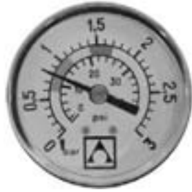
0,8 kg/cm 2 - 11,4 PSI: filitreleme sürecinin başındaki normal basınç
