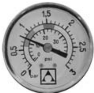
0,8 \text{ kg/cm}^2 - 11,4 \text{ PSI} : Normaldruck bei Beginn des Filtriervorganges.
