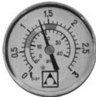
1,3 \text{ kg/cm}^2 - 18,5 \text{ PSI} : Dieser Druck zeigt an, dass ein "SPÜLEN" notwendig ist.
