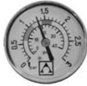
1,3 kg/cm 2 - 18,5 PSI: bu basınç (ters yıkama) zamanının geldiğini gösteriyor
