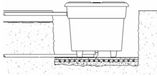
3.5 Der seitliche Durchbruch für das Anschlusskabel muss für den Durchmesser des Kabels passen. Die Kabeldimensionierung ist abhängig vom Leistungsbedarf und Kabellänge.
