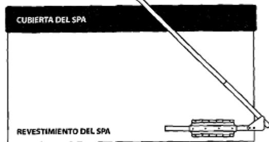
MONTURA EN LA PARTE INFERIOR DEL REVESTIMIENTO DEL SPA – VISTA LATERAL
