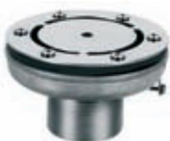
Rosca exterior 2". Fabricada en acero inoxidable AISI-316. Permite su instalación en piscinas de hormigón y prefabricadas. El caudal de agua puede ser regulado mediante el tornillo central. Caudal máx recomendado según norma EN 13451-3: 14m<sup>3</sup>/h.
