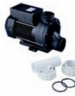
Cuerpo en ABS y 75% FV. Motor de 0,37 kW (0,5 CV). Protección conexión eléctrica IP-55 220 V 1~50Hz. Conexión aspiración 2" macho. Conexión impulsión 1½" macho.
