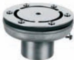
Rosca exterior 2". Fabricada en acero inox AISI-316. Permite su instalación en piscinas de hormigón y prefabricadas. El caudal de agua puede ser regulado mediante el tornillo central. Caudal máx. recomendado según norma EN 13451-3: 14 m³/h.
