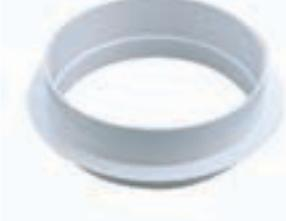
Distanciador adicional para poder aumentar la distancia entre la boca del skimmer de 15 l y la tapa. Distancia alargamiento 25 mm. Fabricado en ABS. Sobreponiendo diferentes acoplamientos se puede aumentar en altura. También puede inclinarse ligeramente para nivelarse con el terreno.
