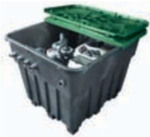
Caseta enterrada inyectada en plástico. Completa y pre-montada alberga en su interior un filtro de hasta 660 mm de diámetro, una bomba, armario de maniobra opcional (modelos C/A), una batería de válvulas y un dosificador (opcional). Para filtros Cantabric, Millennium y Aster. Opcional: Incorporar un dosificador de tabletas de cloro y bromo 4 Kg off-line (Cód. 11130).
