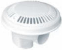
Fabricado en material ABS blanco. Salida lateral de 2" y salida inferior de 1½". Salida inferior tapada con un semitroquelado, lo cual permite que se pueda abrir según necesidad. Posibilidad de montaje de tubo de drenaje (Cód. 21581). Caudal máx: 11 m³/h.
