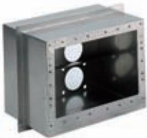
En acero inoxidable AISI-316 de 240 mm de profundidad. Prevista para instalar, tanto en piscina de hormigón, como prefabricada. Suministro con elementos de estanqueidad y dos mangueras pasacables de 3 m.
