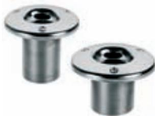
Rosca exterior 1½". Fabricada en acero inox AISI-316. Caudal máx. recomendado según norma EN 13451-3: 4,5 m³/h. Bola Ø 20 mm.
