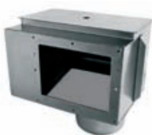
En inox AISI-316. Con rebosadero de Ø 50 mm, cesto y tapa en inox, ambos incluidos. Dispone de alojamiento para montar válvula reguladora de nivel 00256. Con conexión para toma equipotencial. Caudal recomendado: 7,5 m³/h. No incluye embellecedor cód. 00255.
