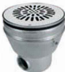
Salida lateral de 2". Fabricado en inox AISI-316. Fijación de la reja mediante tornillos, equipado con juntas, brida y tornillos fijación. Caudal máximo recomendado de 13 m<sup>3</sup>/h.
