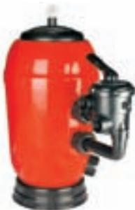
Laminado en poliéster reforzado con FV. Color rojo, pie en polipropileno, tapa sin tornillos, tapón para vaciado de arena y agua, manómetro y purga de aire incorporado en la tapa y válvula selectora lateral. Velocidad máx. de filtración 50 m<sup>3</sup>/h/m<sup>2</sup>. Presión máxima: 2,5 kg/cm<sup>2</sup>. Altura lecho filtrante 0,6 m.
