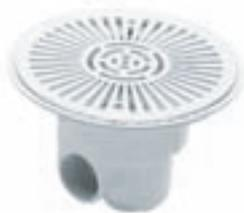
Salida inferior de 1½" y lateral de 2". Construido totalmente en ABS color blanco. Salida lateral con posibilidad de instalación de un tapón para pruebas de estanqueidad. Salida inferior con posibilidad de montaje de válvula hidrostática (Cód. 00277) y tubo drenaje (Cód. 21581). Reja de aspiración Ø 250 mm. Caudal máx: 13 m³/h.
