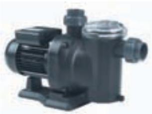
Gama de bombas de nueva generación. Con potencias desde 1/3 CV hasta 1,25 CV en motores monofásicos y desde 3/4 CV hasta 1,25 CV en motores trifásicos. Marcaje GS. Protección motor de 3.000 rpm con protección IP-55, aislamiento Clase F, AISI-316 en todas aquellas partes en contacto directo con el agua. Conexiones a tubería mediante manguito para encolar de diámetro 50 mm.
