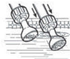
Boquilla de doble uso: para limpiar los residuos del fondo y otra para los de la superficie.
